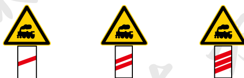
35. 距无人看守铁路道口 50 米 36. 距无人看守铁路道口 100 米 37. 距无人看守铁路道口 150 米
